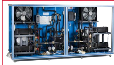
THIBAR44C Equipos de Bomba de Calor + Aire Acondicionado + Refrigeración con Válvula de Inversión de Ciclo , Controlado desde Computador (PC)
