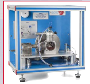
TGFC Turbina de Gas de Flujo Axial/ Motor de Reacción , Controlada desde Computador (PC)
